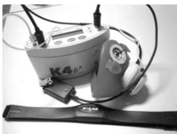
图 1 K4b 2 型便携式运动心肺功能仪(附主机、面罩和心率记录带)
