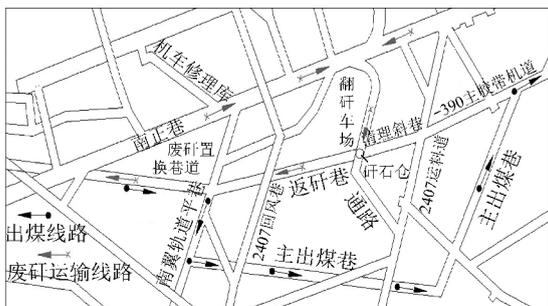
图 8 废矸置换系统布置
