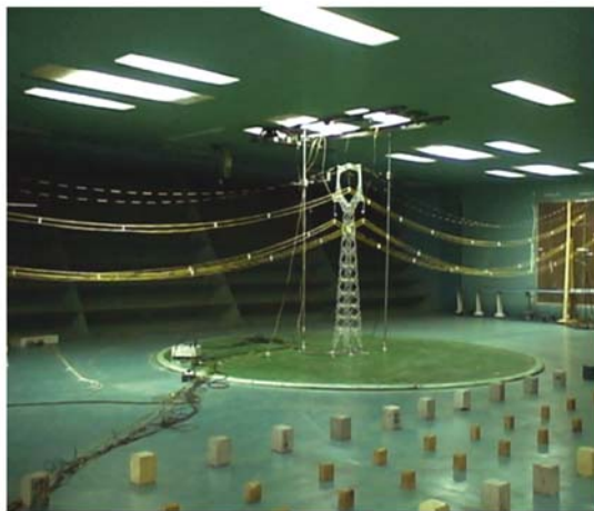
(b) 塔-线体系气弹模型
