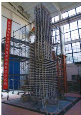
图6 某立面收进高层结构振动台试验模型 Fig.6 Elevation of a shaking table test model with setbacks
