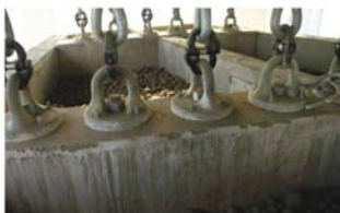
(c) 金属颗粒阻尼器箱安装图
