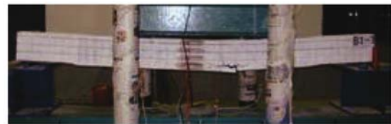
(b) 纤维被拉断破坏(B1-2)
