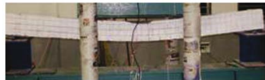
(a) 适筋梁破坏(B0-1)
