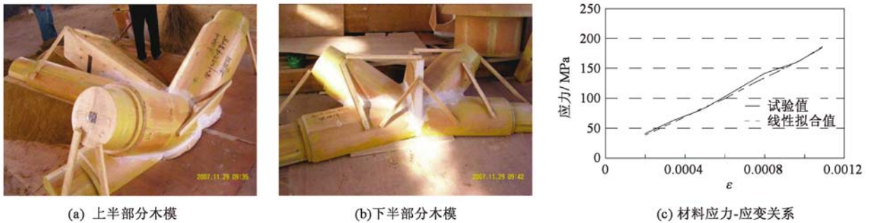
图7 节点制作时的木模以及材料的应力-应变关系
