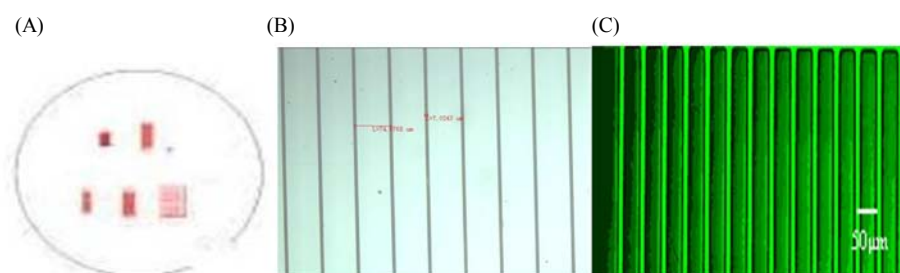
图 1 图案设计、主模版及 PDMS 印章制备 (A) 采用 L-Edit 软件设计的微流体的原始图案 (流道图案线宽: 10 μm, 线间距: 50、100、150、200、300 μm); (B) 光镜下微流体主模板图案 (线间距: 100 μm); (C) 微加工的荧光二抗, 山羊抗兔-488 的图案
