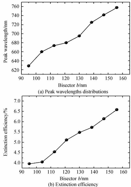
图 2 消光光谱随横向高度  $b$  变化规律
