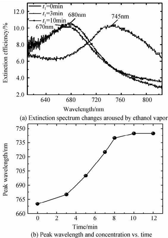
图7 三角形银纳米柱传感乙醇蒸汽实验结果
