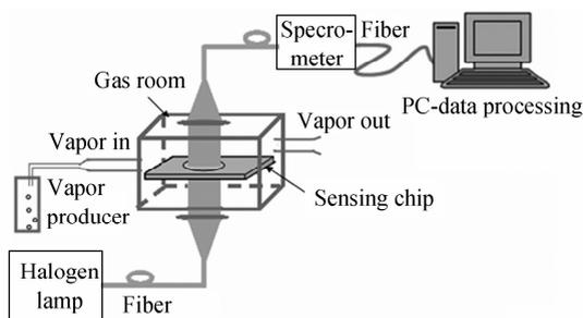
图 6 乙醇蒸汽 LSPR 传感实验系统
