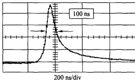
图 5 被动调 Q 的时间波形图
