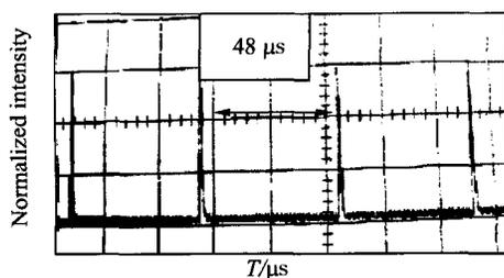
图6 脉冲的重复频率为21 kHz
