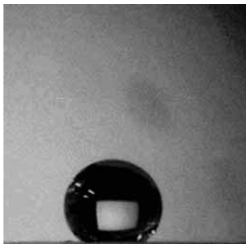
图 7 水滴在压片凝胶材料表面的静态接触角
