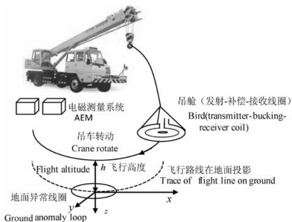
图1 时间域航空电磁系统测试示意图
