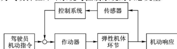
图1 弹性飞机机动载荷减缓控制框图
