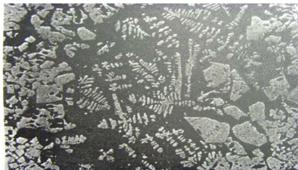
图 2 配比为 60:20:20 的烧结机焙烧球团矿的显微结构 (反光 150×) Fig. 2 Microstructure of sintering pellet at ore proportioning of 60:20:20
