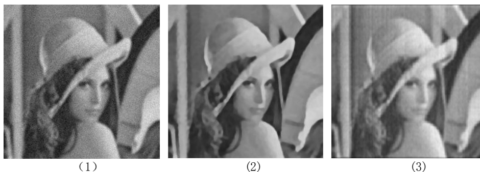
图 4.1 (1)待复原的模糊噪声图像 (2) TV 方法迭代 600 次复原后的图像 (3) FP-ADI 方法迭代 4 次复原后的图像
