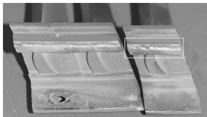
图2 第36组LPT4静子叶片固定沟槽断裂 Fig. 2 Hook fractured at No. 36 LPT4 vanes
