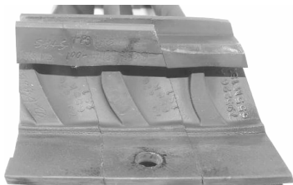
图3 第42组LPT4静子叶片部分固定沟槽断裂 Fig. 3 Partial hook fractured at No. 42 LPT4 vanes
