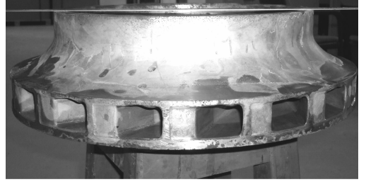
图4 由1号阴极加工完成的部分型腔 Fig. 4 Part cavities processed by cathode No. 1
