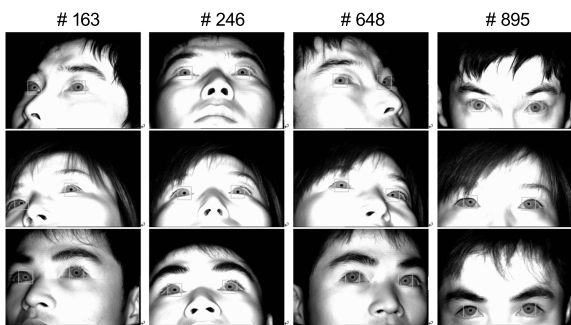
图 18 不同头部位置的眼睛跟踪及参数提取 Fig. 18 Eye tracking and parameter extraction undergoing significant face pose changes
