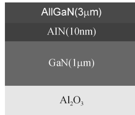
图1 AlGaIn生长模型图
