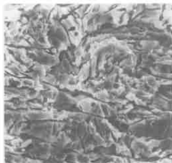
图1 酸蚀组瓷面呈粗糙不平、形态不规则之凹凸结构 ×1000
