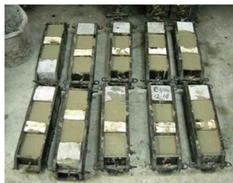
(b) 试样浇筑现场
