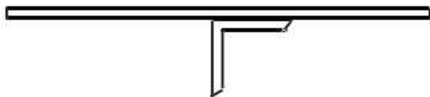
图 3 扁钢与角钢接地极间的电焊图
