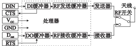
图3 XBee-PRO模块的内部数据流程图
