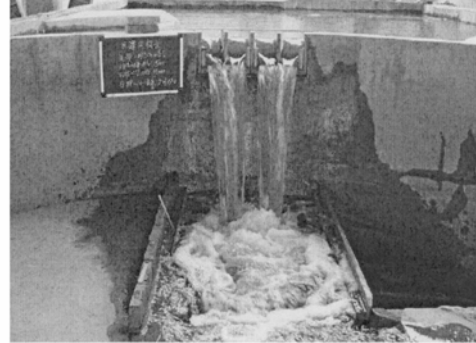
图7 P60模型流态(Q=1330m 3 /s)
