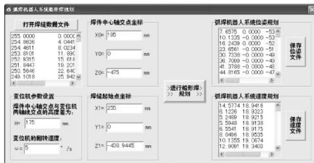
图 4 弧焊机器人系统船形焊规划软件
