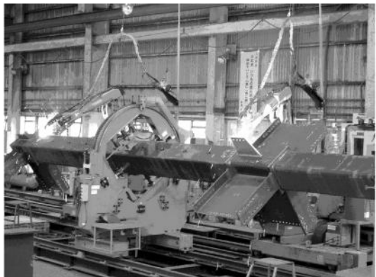
图 12 Bracket 方式(矩形钢管,双电弧焊接机器人系统 ② )
