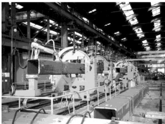
图 11 Non bracket 方式(矩形钢管,单电弧焊接机器人系统)
