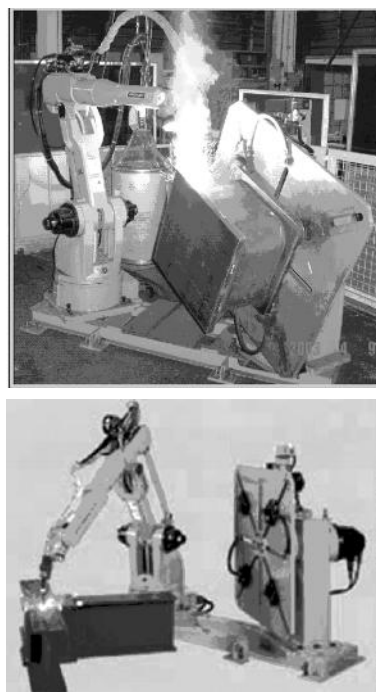
图 14 核心、接头处的兼用焊接机器人系统
