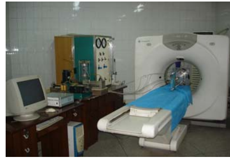
图2 后勤工程学院汉中 CT - 三轴工作站
