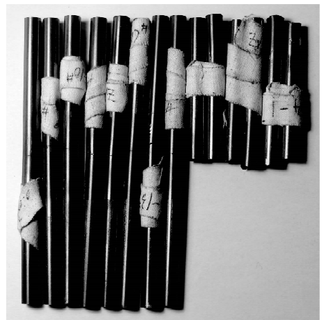
图 2 Zr-4 试样疲劳断裂情况
