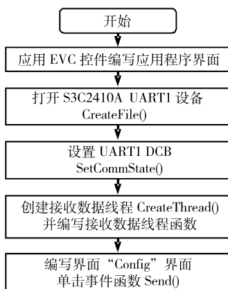
图 3 ZigBee 网络配置应用程序流程图 Fig. 3 Flow chart of configuration program for ZigBee networks
