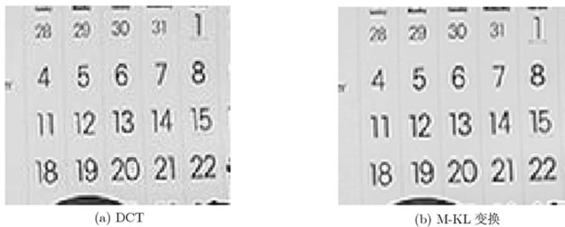
图 4 视频例子 Mobile 中的 I 帧分别采用 DCT 变换和 M-KL 变换的主观效果比较
