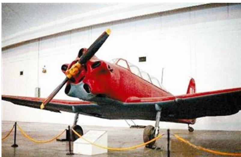
雅克-18飞机是前苏联雅克福列夫设计局设计的初级教练机，1945年末首次试飞后，投入批量生产。该飞机是构架式机身、下单翼的初级教练机，为空军训练用的基本机种。该飞机最大平飞速度为每小时248公里，最高升限4000米，如以最经济耗油量的速度飞行，最大航程可达1000公里。座舱内的航行仪表及设备，可用于夜航训练。该飞机稳定性好，易于操作，起飞滑跑距离仅需205米，起落架可收放。雅克-18飞机除原型外还有7种改型。到1967年止，共生产各型雅克-18飞机8000架，包含1240架可载乘客3人的运输机改型——雅克-18T。
