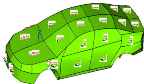
图 6 轿车统计能量分析模型 Fig. 6 Car SEA model
