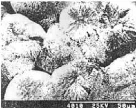
图 1 PP 球晶形貌扫描照片
