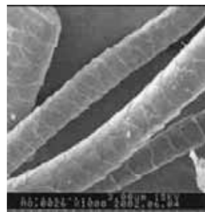
图 2 羊毛纤维 10℃,75%硫酸 反应后的纵面形态
