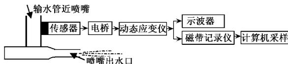
图 3 喷水压力测试方框图
