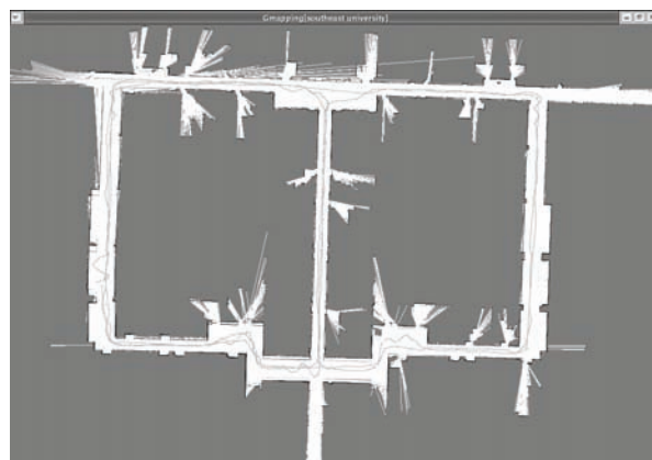
图 8 应用 Gmapping (50 个粒子条件下) 生成的地图
