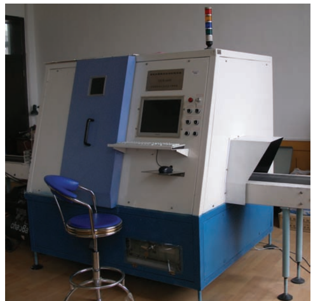
图 8 注射剂智能检测系统实物图
