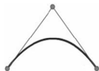
图 1 由 3 点定义的二次贝塞尔曲线
