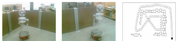
(a)机器人在导航过程中的一系列运动 (b)机器人在导航过程中的一系列运动 (c)走廊环境中数据栅格保存的TDD和ODD信息
