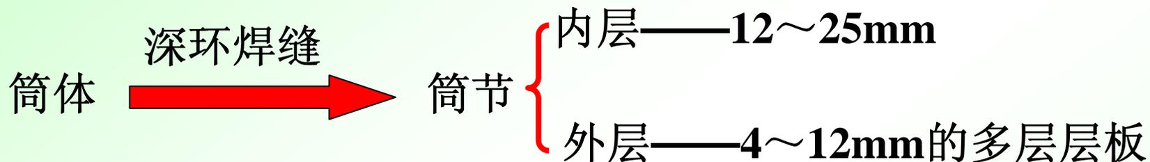
为避免裂纹沿壁厚方向扩展，各层板之间的纵焊缝应相互错开 $75^\circ$ 。
