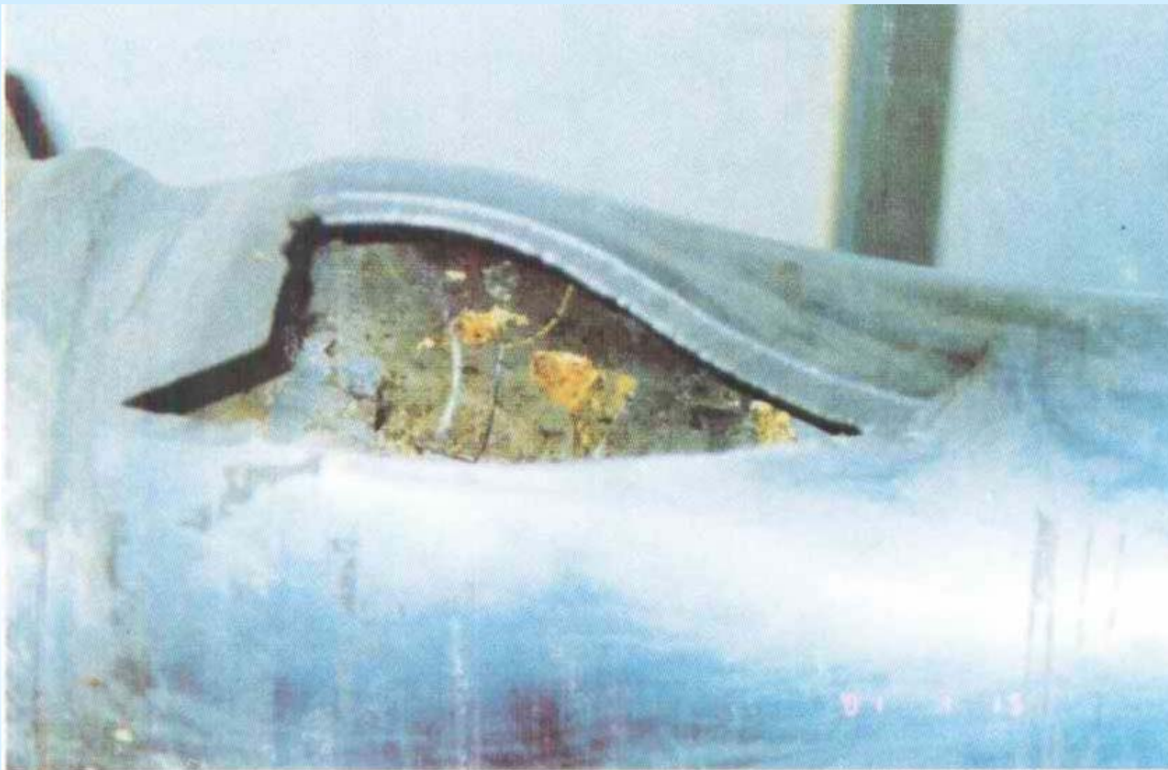
图3 薄壁容器 韧性断裂外观
