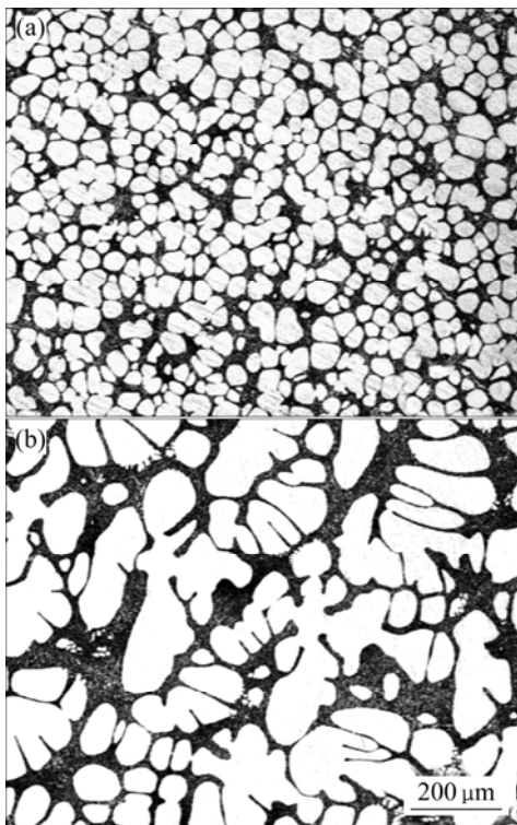
图5 不同振荡室倾角下的对 A356 合金半固态微观组织
