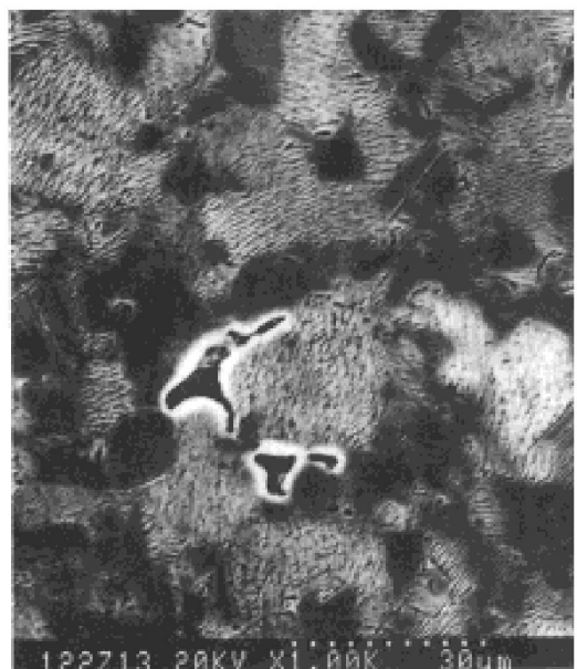
图 4 存在于晶隅处的孔洞的 SEM 二次电子像分析结果
