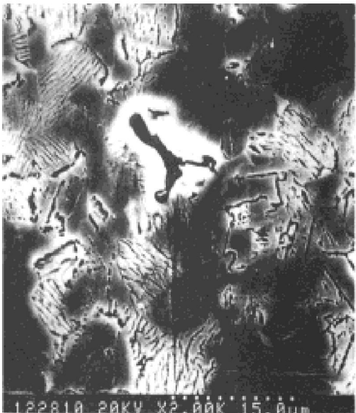
图6 全层片状组织试样高温拉伸试验后显微组织形貌 SEM 二次电子像照片
