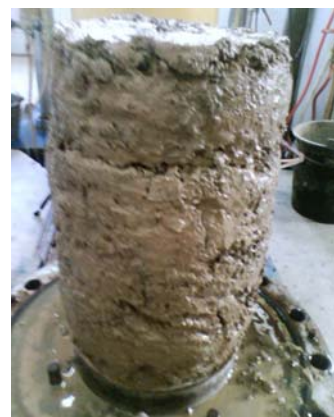
图6 破坏的大三轴试验试件
