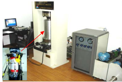
图2 TLW-2000型岩石三轴蠕变试验机
