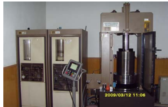
图 2 岩石力学试验系统 MTS815
