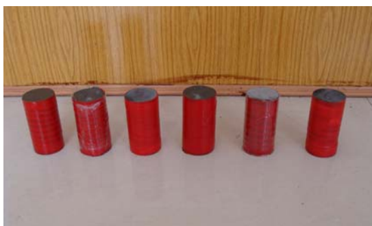
图 1 软弱泥岩三轴压缩试验试件
