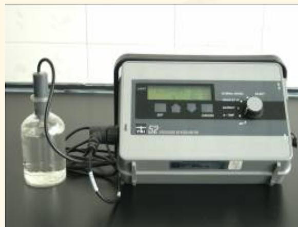
YSI 752型溶解氧测定仪
