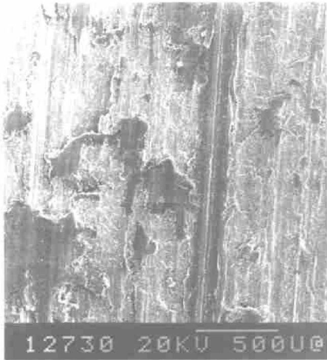
图 7 浸渍金属碳滑板对磨铜环电镜照片(×40)
