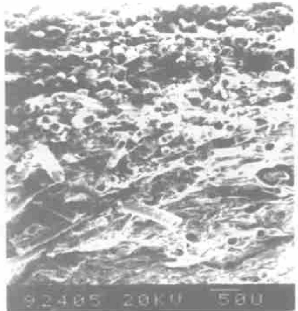
图6 碳纤维集聚试样断口电镜照片( \times 120 )
