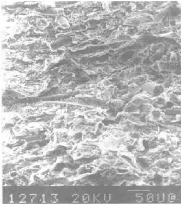
图4 碳纤维杂乱无章的排列( \times 200 )
