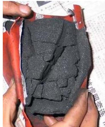
图 13 含瓦斯煤样的破坏形式
