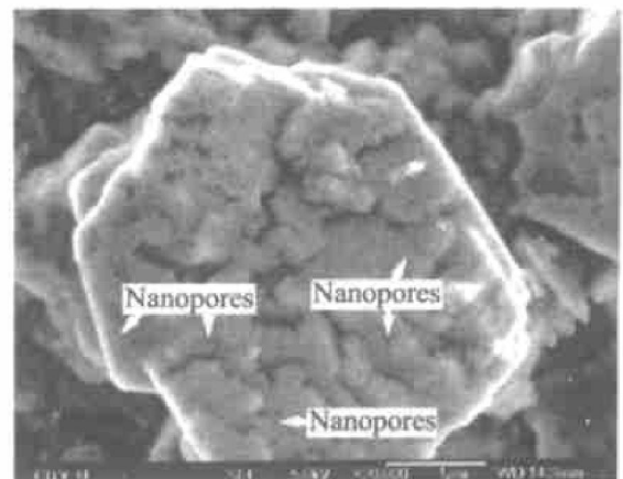
图 2 阳极氧化铝的表面形貌
