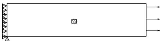
图4 宏观均质模型示意图 Fig.4 Sketch map of homogenous material model
